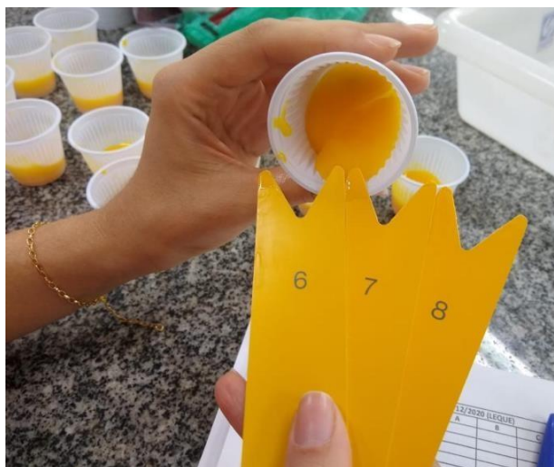
Figura 4. Avaliação da coloração das gemas por Lequecolorimétrico da DSM. Fonte: Arquivo pessoal.
