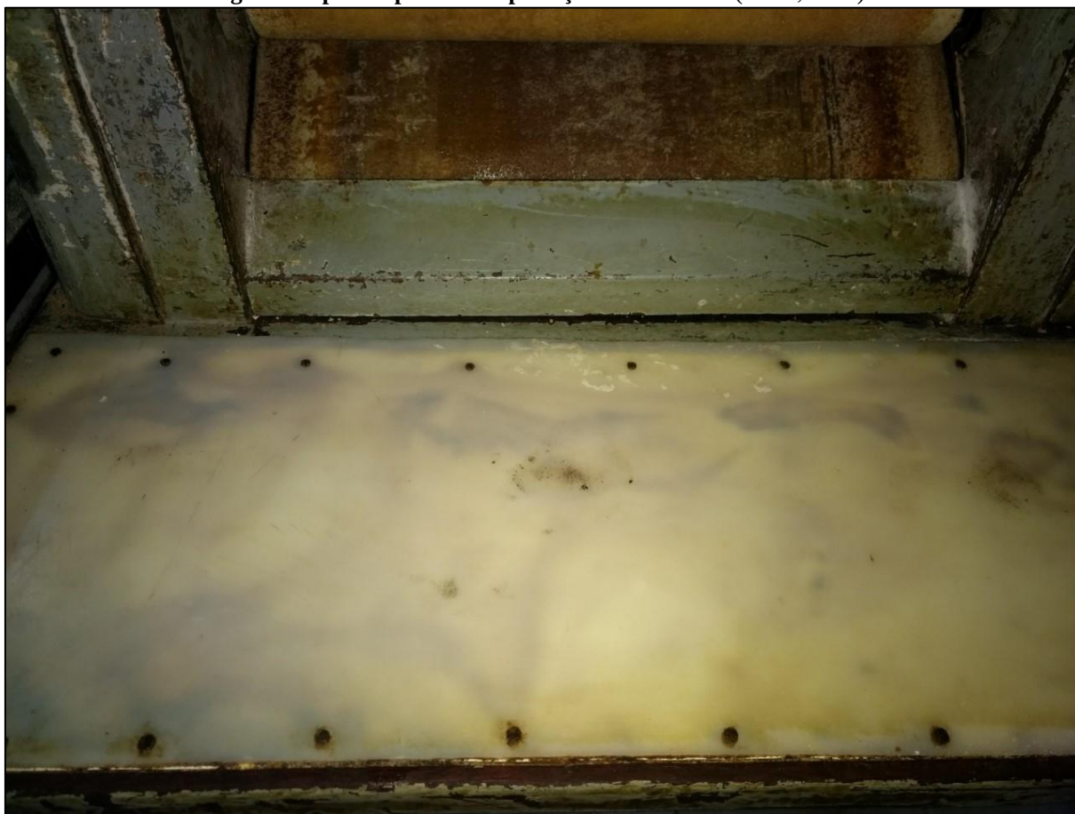
Figura 11: mesa aonde a massa do pão é esticada com parafusos enferrujados. Fonte: (Pinho, 2020).
