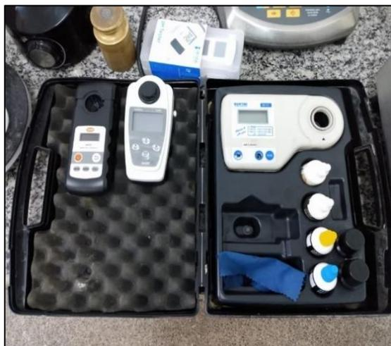
**Figura 30:** Equipamentos de dosagem de cloro (modelo MI404), pHhep<sup>®</sup>, turbidímetro (modelo TU430) e cor (colorímetro modelo AK530). Fonte: Arquivo Pessoal (2020).
