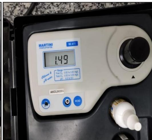
**Figura 31:** Equipamento fotômetro (modelo MI404) para dosagem do cloro evidenciando o percentual encontrado na água. Fonte: Arquivo Pessoal (2020).
