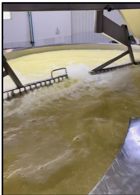
Figura 23. Etapa de corte da massa da coalhada na queijomatic. Fonte: Arquivo Pessoal (2022).
