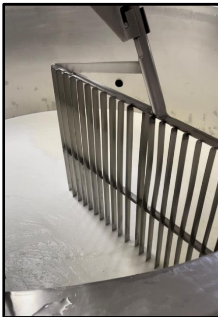
Figura 22. Leite pasteurizado com a adição de ingredientes em agitação na queijomatic. Fonte: Arquivo Pessoal (2022).
