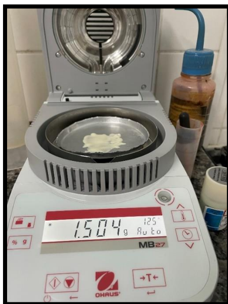
Figura 26. Amostra de requeijão em analisador de umidade halógeno. Fonte: Arquivo Pessoal (2022).
