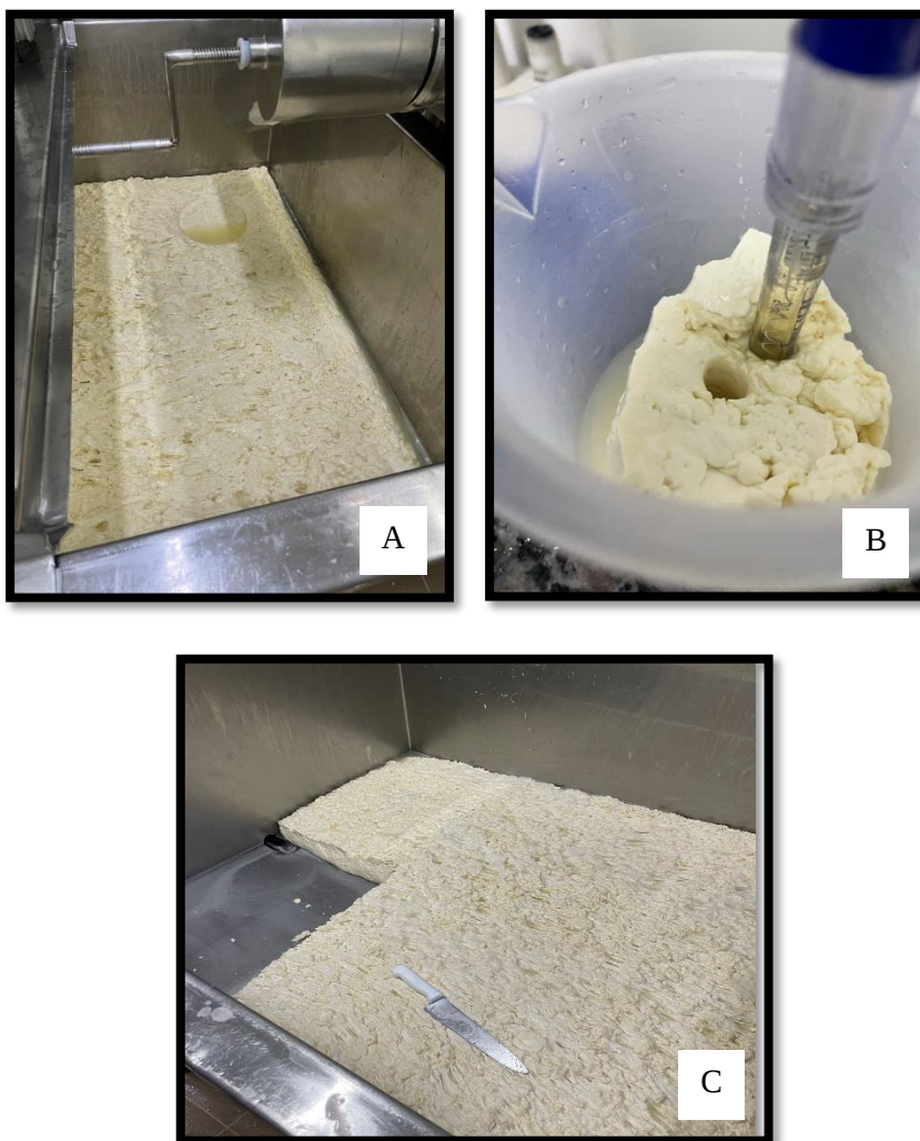
Figura 24. Massa fermentada em espera até atingir o ponto ideal de pH (A), análise de pH da massa (B), e corte da massa liberada para máquina de fundir requeijão (C). Fonte: Arquivo Pessoal (2022).
