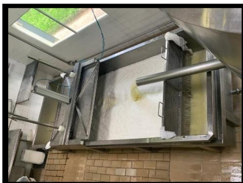
**Figura 13.** Dessoragem parcial realizada na drenoprensa.
