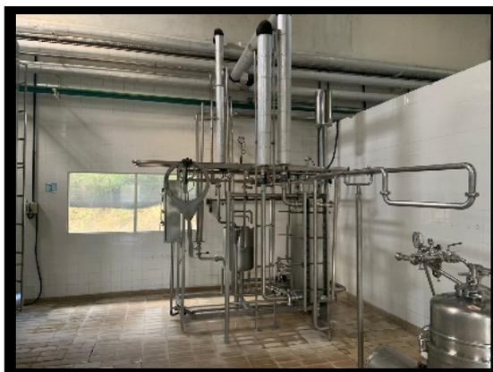
**Figura 8.** Equipamento pasteurizador a placas.
