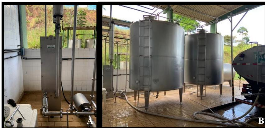
**Figura 7 A e B.** Trocador de calor e tanques de estocagem da área de recepção de matéria-prima.
