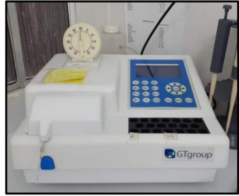
**FIGURA 21** – Analisador Bioquímico semiautomático da marca GTgroup®, modelo SX 3000M. Fonte: arquivo pessoal (2022).
