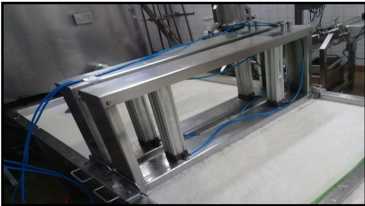
Figura 16. Início do processo de dessoragem na drenoprensa, visitado durante a realização do ESO do período de 12 de abril a 30 de junho de 2021.
