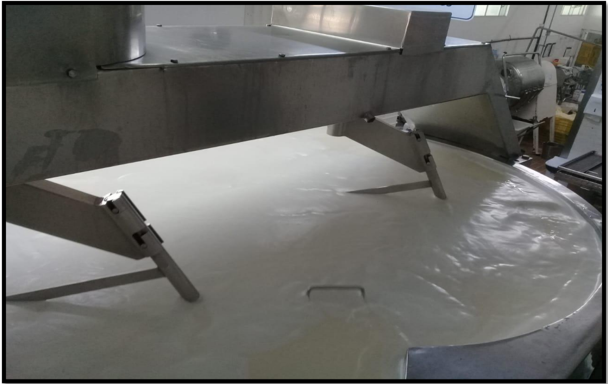
Figura 14. Tanque de coagulação com leite previamente pasteurizado e adicionado de ingredientes, visitado durante a realização do ESO do período de 12 de abril a 30 de junho de 2021.
