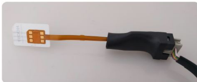
Figura 5. Adaptador que é inserido no celular e se comunica com a placa do MSSB. Fonte: Qualigon
