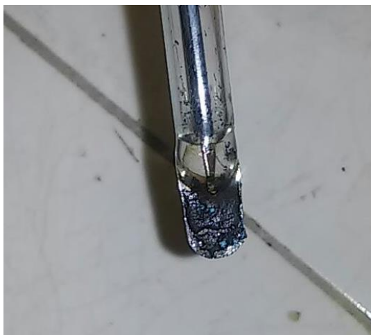
Figura 6: Eletrodo de trabalho modificado, Pt/MOF/cMoL.
