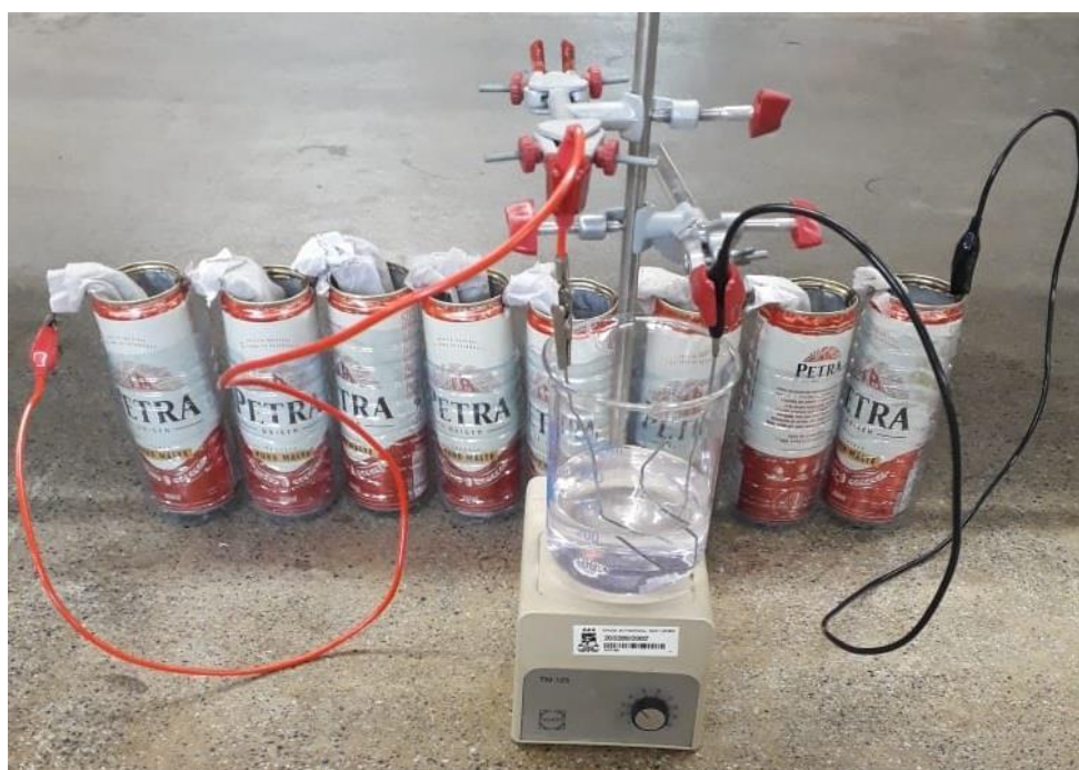
Figura 8: Pilha composta por latas de alumínio contendo solução de corante índigo-carmim. Fonte: Elaborado pelo autor (2019).
