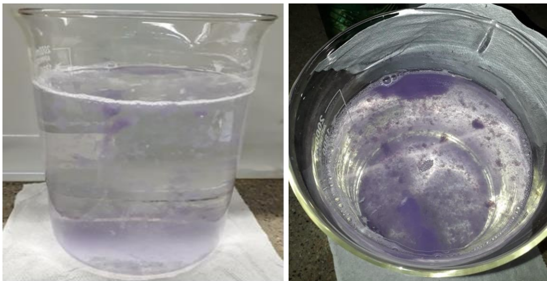
Figuras 11 e 12: Solução de corante exibindo o processo de coagulação do mesmo após o tratamento eletroquímico.
