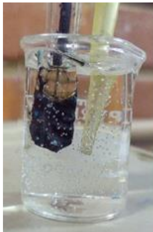
Figura 7: Célula eletroquímica, contendo o eletrodo de referência Ag/AgCl e o eletrodo de trabalho modificado, Pt/MOF/cMoL, ambos ligados a um medidor potenciométrico.
