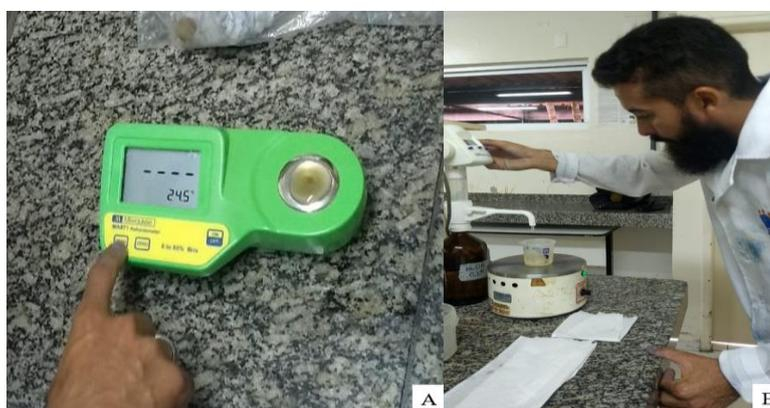
**Figura 4.** Determinação de teor de sólidos solúveis em refratômetro digital (A) e acidez titulável (B) de acessos de uva. Embrapa Semiárido, Petrolina-PE, 2019.
