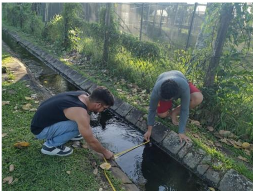
Figura 4. Aspecto de medição de seção transversal do canal de abastecimento. Fonte: Arquivo Pessoal.
