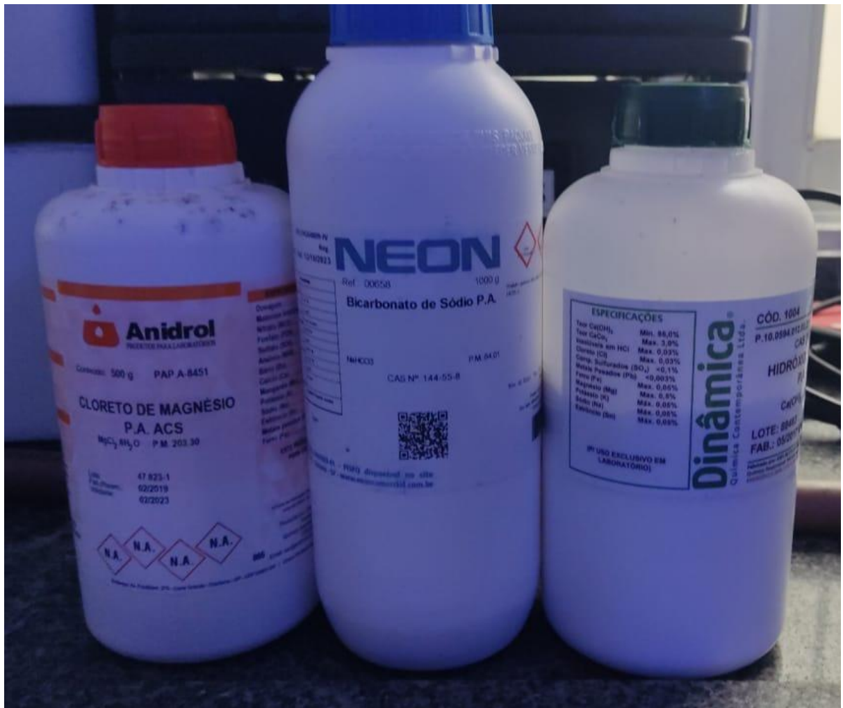
Figura 4. Sais utilizados em solução em água deionizada para reposição de elementos essenciais ao bom funcionamento do sistema. Cloreto de magnésio ( MgCl_2 ), para reposição de Mg; bicarbonato de sódio ( NaHCO_3 ) para a manutenção da dureza de carbonatos; e hidróxido de cálcio ( Ca(OH)_2 ) para a reposição de cálcio.
