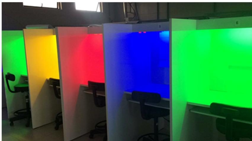
**Figura 4. Bancada de análise sensorial equipadas com lâmpadas fluorescentes**
