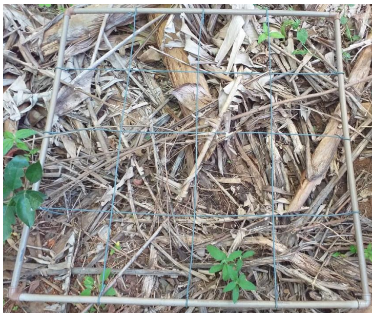
Figura 7: Artefato de PVC e nylon para aferição da cobertura do solo
