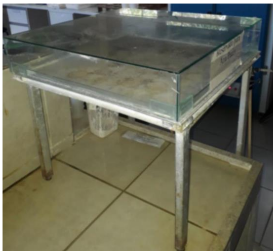
Figura 4. Mesa de tensão, utilizado para determinação da macroporosidade do solo, pertencente ao Laboratório de Física do solo da Universidade Federal Rural de Pernambuco.
