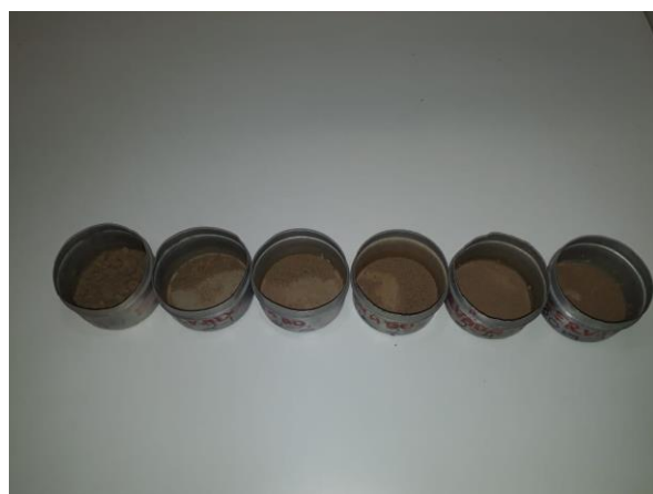
Figura 2. Transferência do material retido nas peneiras para latas de alumínio e material em latas após seco em estufa.
