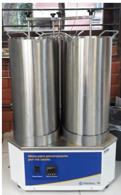
Figura 1. Aparelho de oscilação vertical utilizados nas análises de peneiramento por via úmida, pertencente ao Laboratório de Física do solo da Universidade Federal Rural de Pernambuco.
