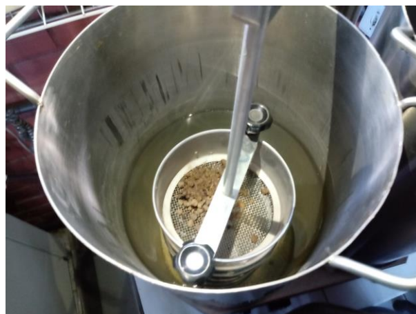
Figura 1. Aparelho de oscilação vertical utilizados nas análises de peneiramento por via úmida, pertencente ao Laboratório de Física do solo da Universidade Federal Rural de Pernambuco.
