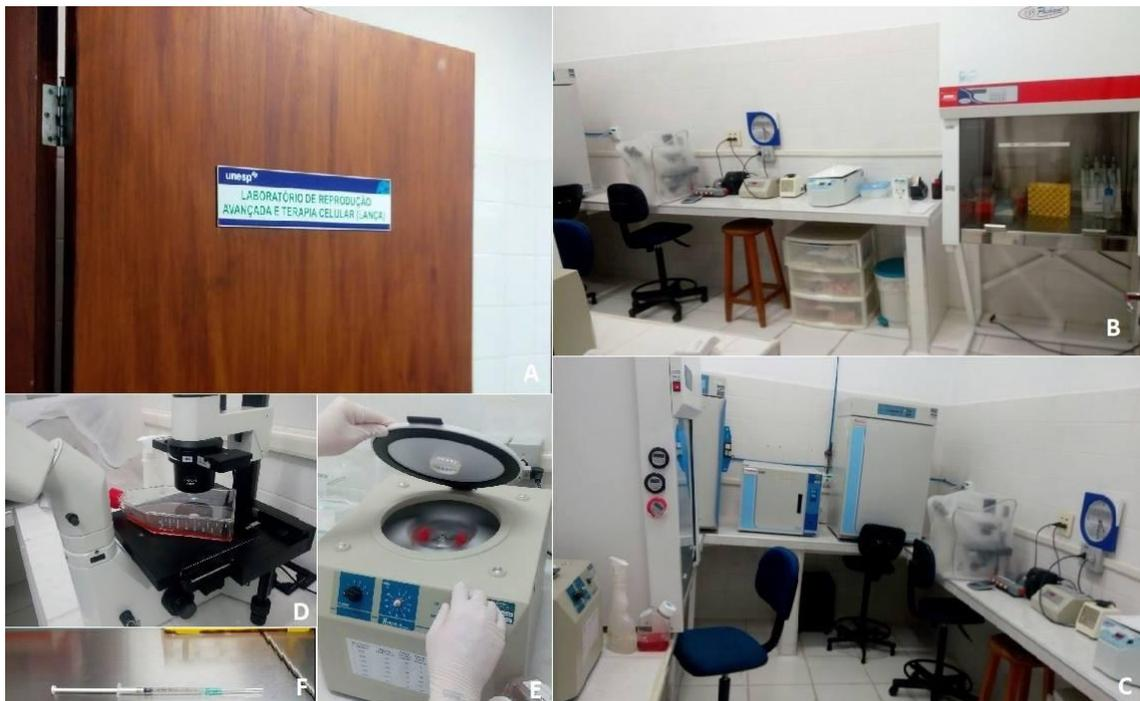
Figura 19-Laboratório de Reprodução Avançada e Terapia Celular (A), destacando câmara de fluxo laminar, banho-maria, microscópio óptico (B), estufas e centrífuga (C). Observação das células-tronco mesenquimais cultivadas em microscópio óptico (D), centrifugação da solução com células-tronco (E) e células-tronco prontas para o transplante (F). Fonte: Arquivo pessoal (2018).
